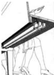
Ilustracija 6 Konvektivni uređaj za grijanje ugrađen u klupu
